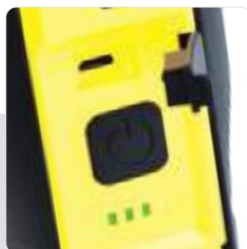
Micro-USB Ladeanschluss und Kapazitätsanzeige
