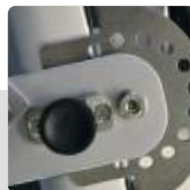
Rastbolzen mit Verstellmechanismus
