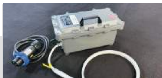
ATEX Treiberbox mit Anschlusskasten und EX-Stecker
